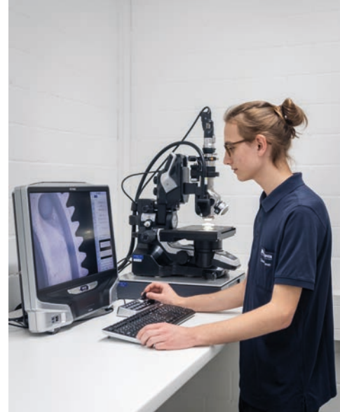
^ Cédric Bernet utilizza diversi strumenti di misurazione per controllare la qualità di un ingranaggio in plastica.
